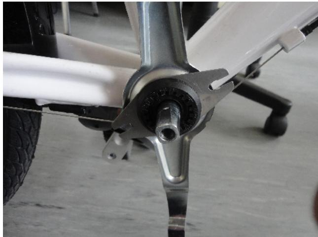
*Tretlager mit Kettenschutzbrille & Positionshalter*
