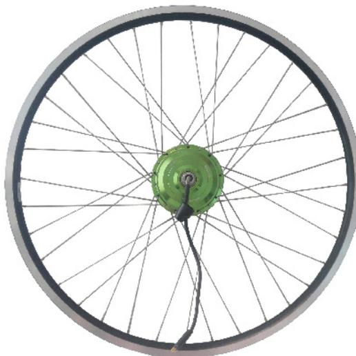
Abb.3: Eingespeichertes Laufrad mit Vorderradmotor
