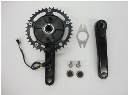
Abb.1: 1-fach C-Feder Drehmomentsensor
