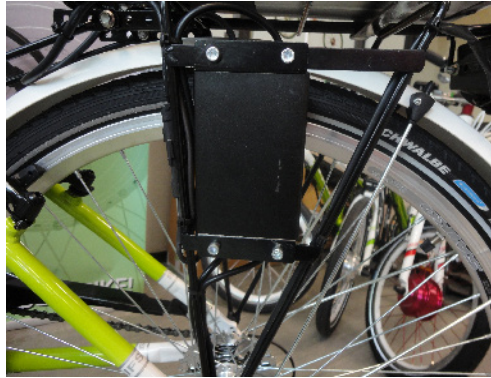
Abb 9: Montageplatz des Controllers
