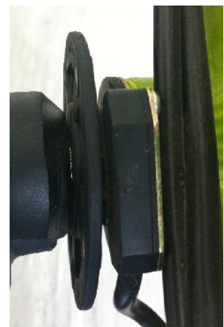
Abb 16: Richtige Position Magnetscheibe/Sensor
